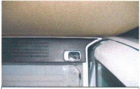
MAKE SURE BRACKET IS VERTICAL INSIDE OF STAKE POCKET, BEFORE PLACING FOOT OVER TOP OF IT
